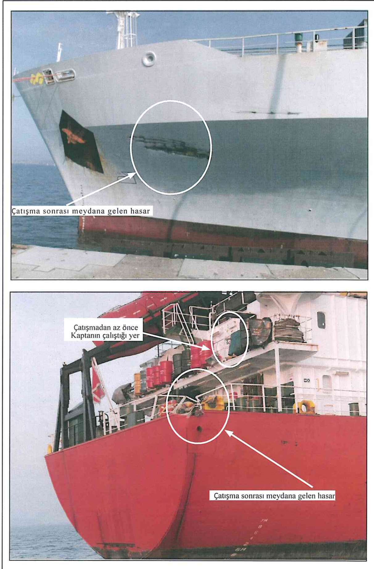
Figür 1: Çatışma sonrası gemilerde oluşan hasar.
