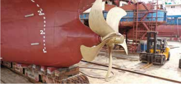
M/V ERGE'ye retrofit olarak dizayn edilip takılan Gate Rudder'in seyir tecrübelerinden önce yakından görüntüsü
