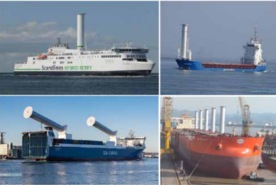
Şekil 5: Çeşitli gemi tiplerinde Flettner rotor uygulamaları
